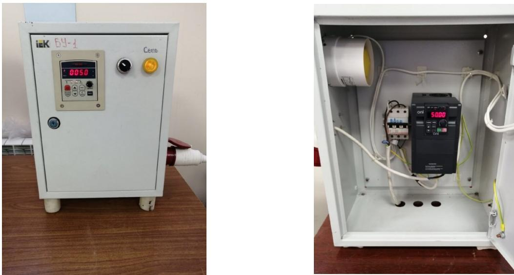
Рис. 3. Шкаф управления вибраторами вибrostола (а) и вибратора ИВ-99Б (б)
