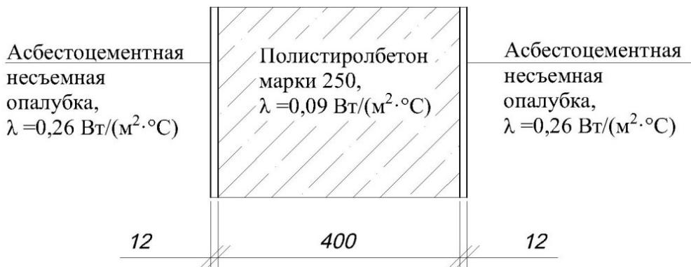
Рис. 2. Теплотехнические показатели проектируемого ограждения из полистиролбетона
