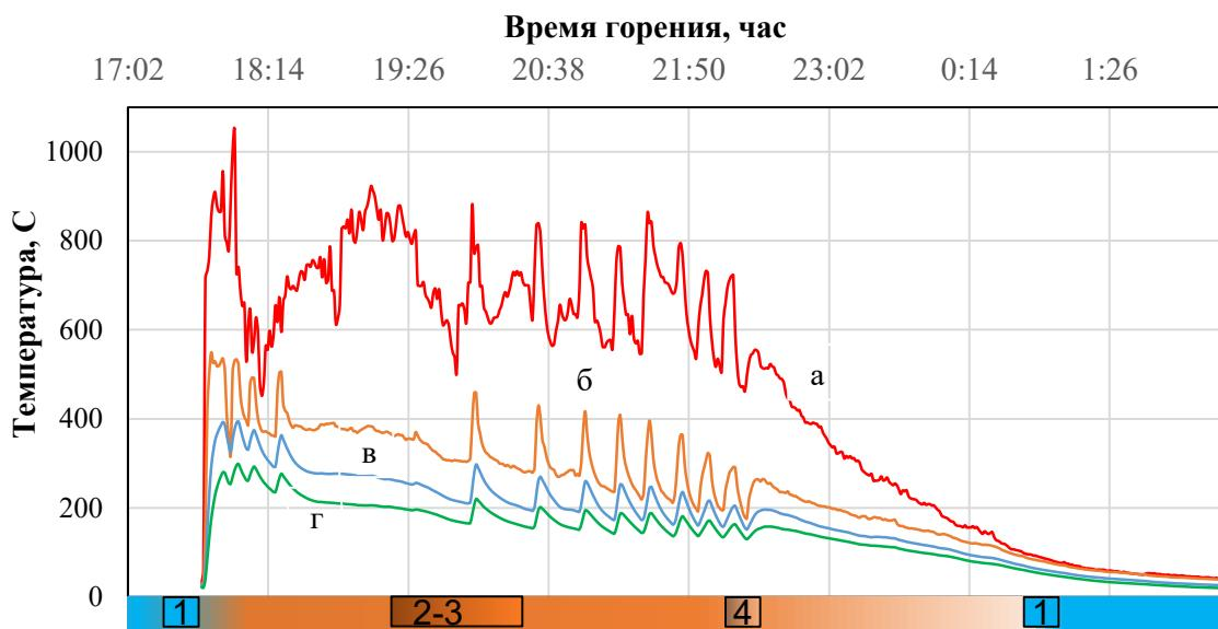
Рис. 6. Процесс горения котла на 1 закладке дровяного топлива:
